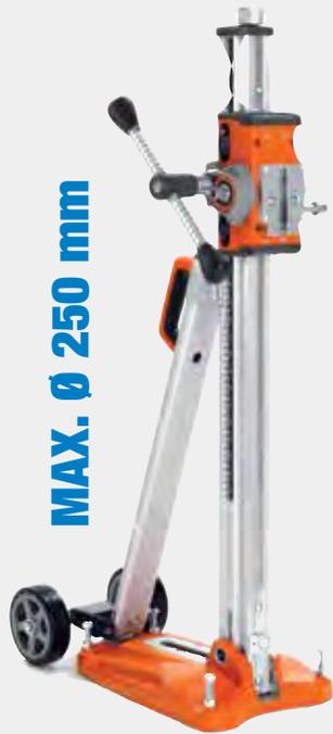
Der DS 250 ist der mittelgroße Bohrständer in der neuen Bohrständerfamilie von Husqvarna. Dieser leichte Bohrständer aus Aluminium hat Transporträder am Bohrständerfuß, und ist sowohl für Vakuum- als auch für Dübelbefestigung vorbereitet. Die Spreizschraube an der Säulenoberseite dient der sicheren Befestigung beim Bohren in Böden und Decken.
