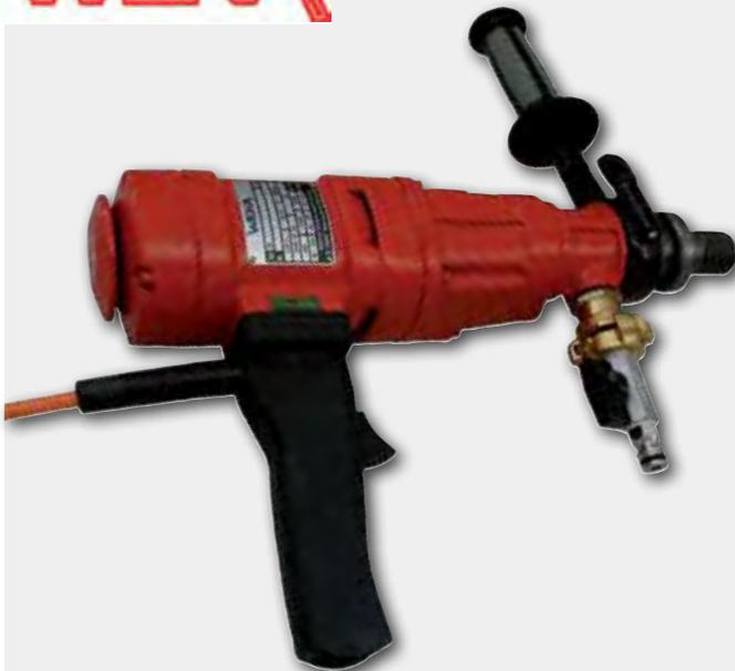
Die DK17 ist eine universelle Nass-Trocken-Kernbohrmaschine zum Bohren von armiertem Beton (Nassbohren) und Mauerwerk (Trockenbohren), ohne aufwändiges Wechseln von Zubehör oder Vorsatzeinrichtungen. Einfach nur Kugelhahn, oder Vakuum-Saugtülle ankuppeln, schon ist die Maschine für den Bohreinsatz gerüstet.
