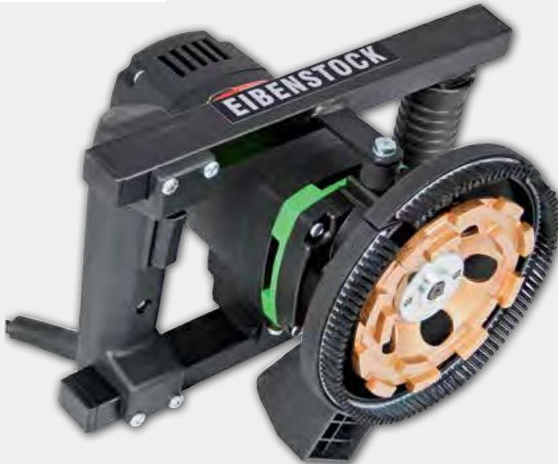
**Typ EBS 125.4 RO** mit Drehzahlregelung von 6.000 bis 10.000 Upm zum Absenken der Drehzahl für die Bearbeitung von Gips, Kalksandstein und Holz mit hartmetallbestreuten Scheiben.
